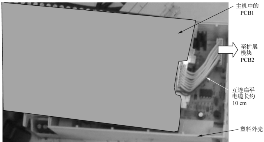
图 3.61 主机中的 PCB 和扩展中的 PCB 互连部分的实物照片
