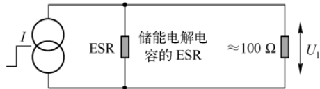
图 4.39 没有差模滤波电路的开关电源传导骚扰测试等效电路图
