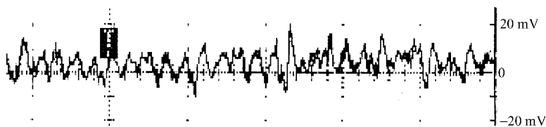
图 6.117 经过修改后的噪声峰-峰值
