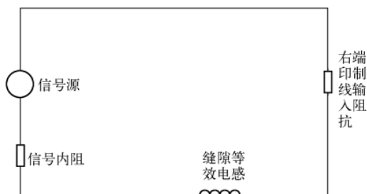
图 6.69 跨越裂缝区的信号传输等效电路
